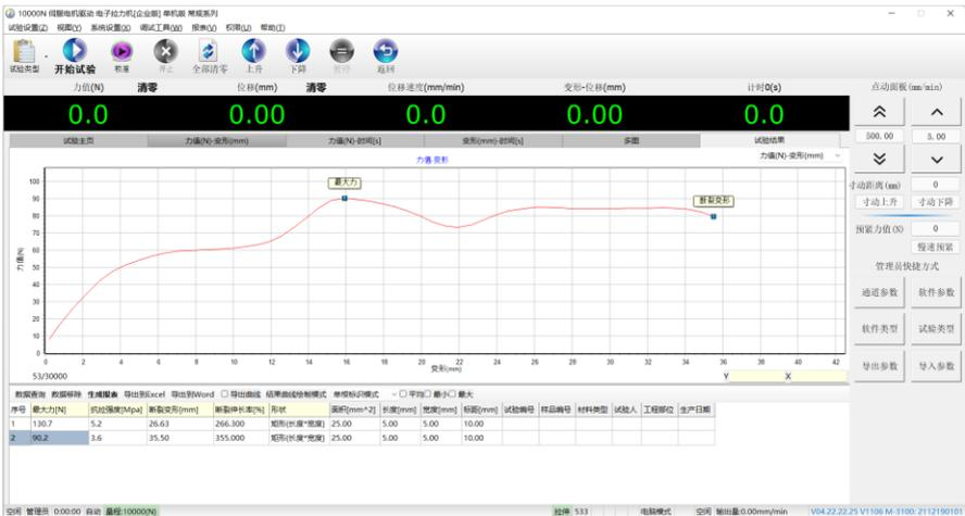
选择单根标识模式，曲线上会自动添加特征点标识方便进行试验材料性能分析。曲线右上角可以切换坐标系，图示为力值（N）-变形（mm），可下拉选择需单根呈现的曲线。结果页面下侧有数据查询、数据移除、报表生成及选择平均值/最大值、最小值的查看等功能。数据列表里，带黄色背景的数据为只读数据，不能修改，其它数据可以修改，且在修改确认后，软件将自动重新计算绘制曲线并重新标识特征点。
