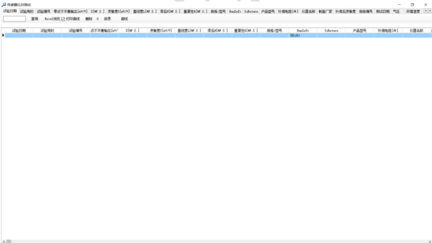
左上方的页面为查询条件，默认按照试验日期查询，也可以选择试验编号等。文本框输入查询内容，点**查询**，软件将自动给出匹配的试验结果。通过选中某个试验结果，
